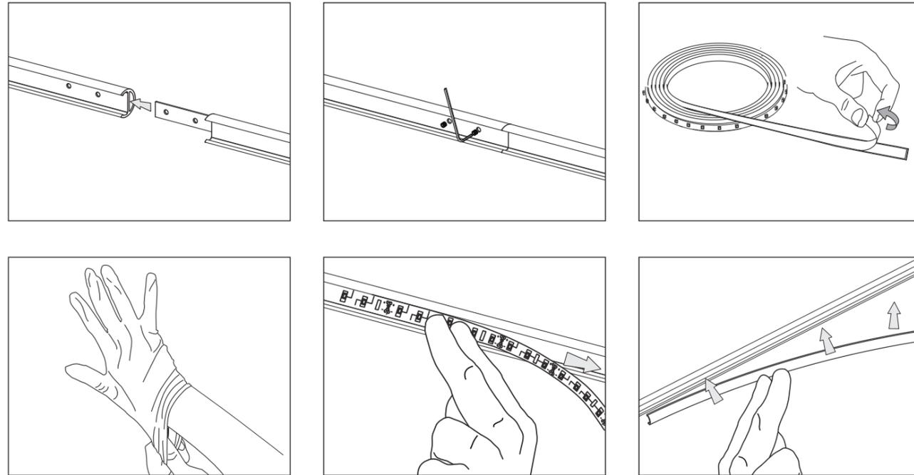
L'installazione avviene in modo molto semplice; il profilo in alluminio, bianco e nero, è fornito in lunghezza da 2,5 o 3 metri e viene assemblato e tagliato in opera a seconda delle esigenze. L'applicazione del circuito flessibile, fornito già con il cavo di alimentazione coassiale, è successiva e può essere regolata con una possibilità di un taglio ogni 5 cm. L'operazione si completa con l'applicazione del diffusore in policarbonato opalino che chiude il profilo.
