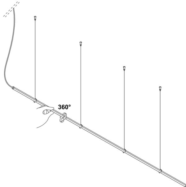
Il profilo può ruotare sul suo asse di 360° per orientare la luce - *The profile can rotate on its axis of 360° to direct the light*
