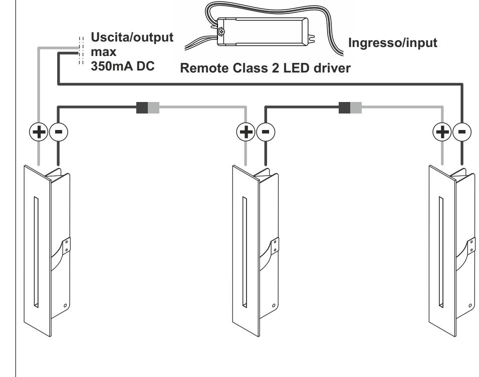
**Per evitare di danneggiare il LED effettuare tutti i collegamenti prima di dare tensione -
